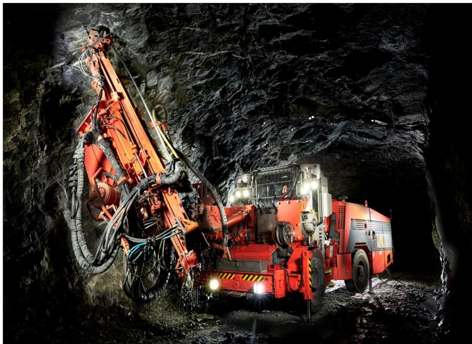
Abb. 2: Sicherungsarbeiten mittels Ankerbohrwagen in Mittersill
