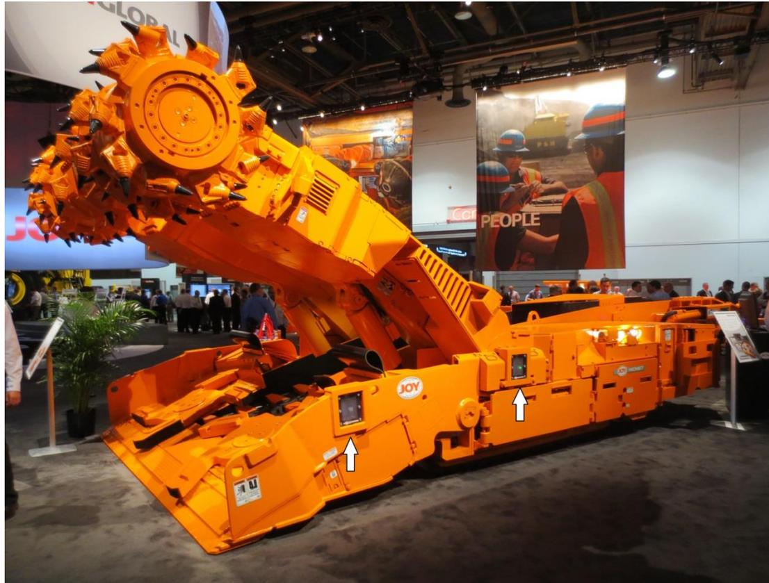
JOY Continuous Miner 12CM mit dem Matrix M3-1000 Proximity Detection System, auf der Las Vegas Mining Show im September 2012. Die Feldgeneratoren bei diesem System sehen aus wie quadratische Fenster (Foto: N. Sifferlinger)
